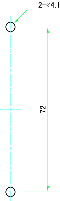
* 取付穴寸法 / Mounting hole dimensions
